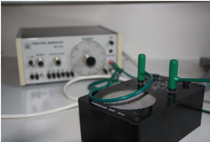
Slika 4: Frekvenčni generator in zvočnik, napravi za poskus Foto: V. Šoster, januar, 2010
