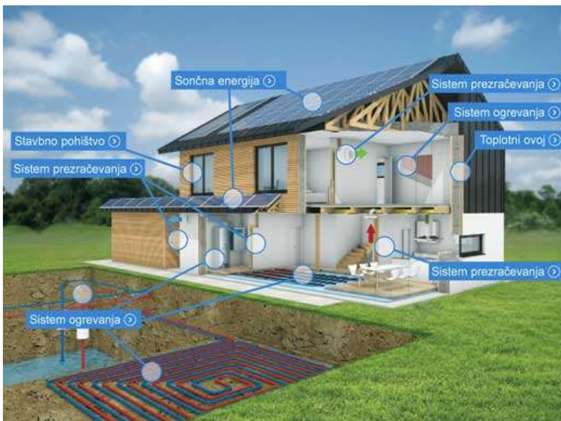
Slika 23: Shema delovanja nizko-energijske hiše
