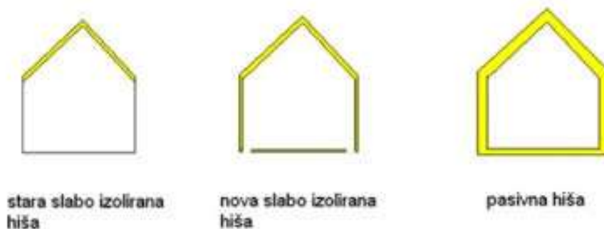
Slika 31: Primer klasične izolacije in izolacije pasivne hiše
